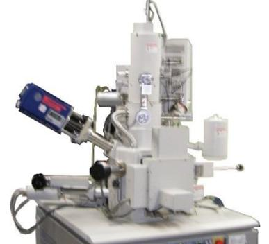
電界放射型走査電子顕微鏡 (FE-SEM+EDX)
