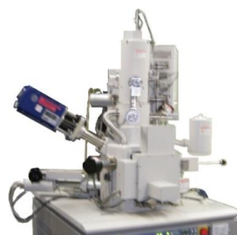
電界放射型走査電子顕微鏡 (FE-SEM+EDS)
