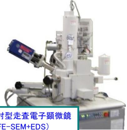
電界放射型走査電子顕微鏡 (FE-SEM+EDS)
